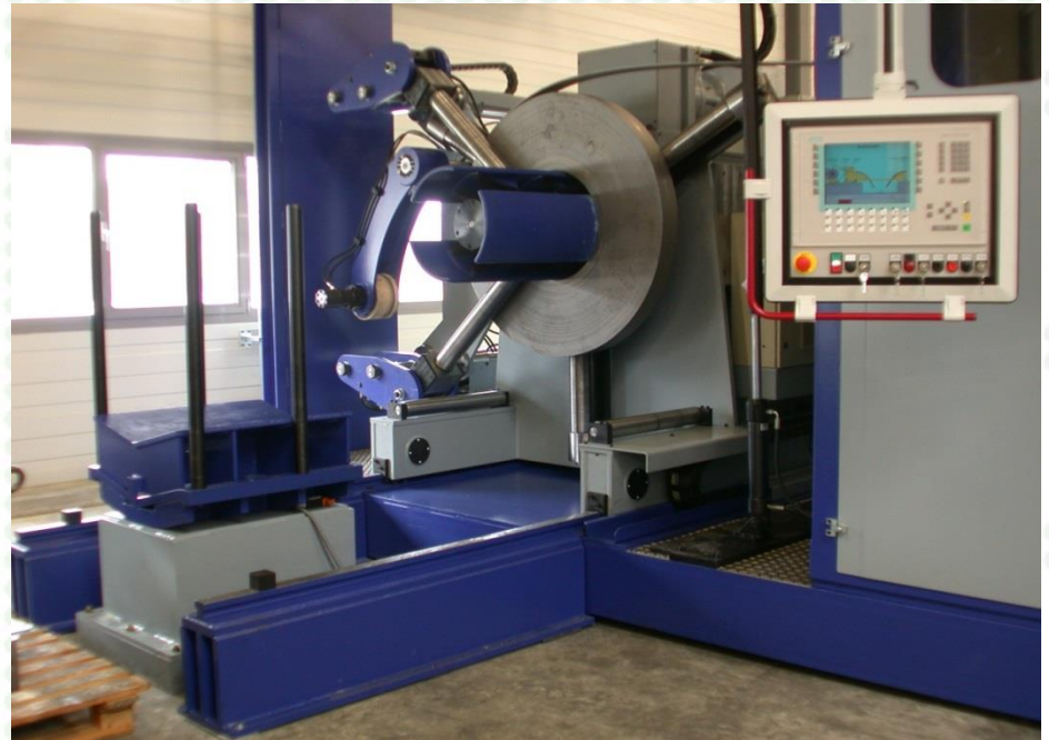
Bandanlage für Feinstanzpresse Querschnitt max. 500 x 14
